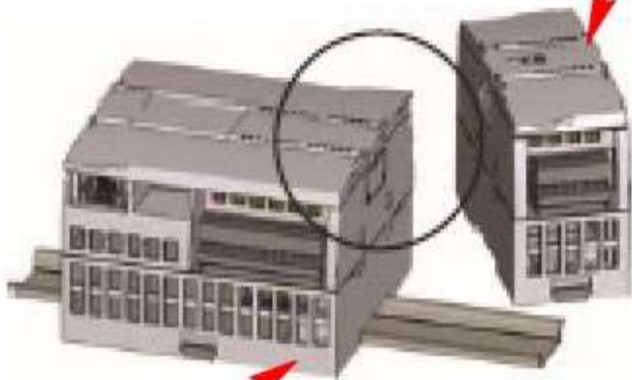
CPU уже установлен на DIN-рейке
