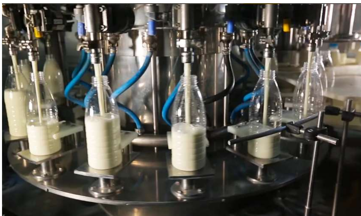
Автоматическая линия розлива молока – участок наполнения бутылок
