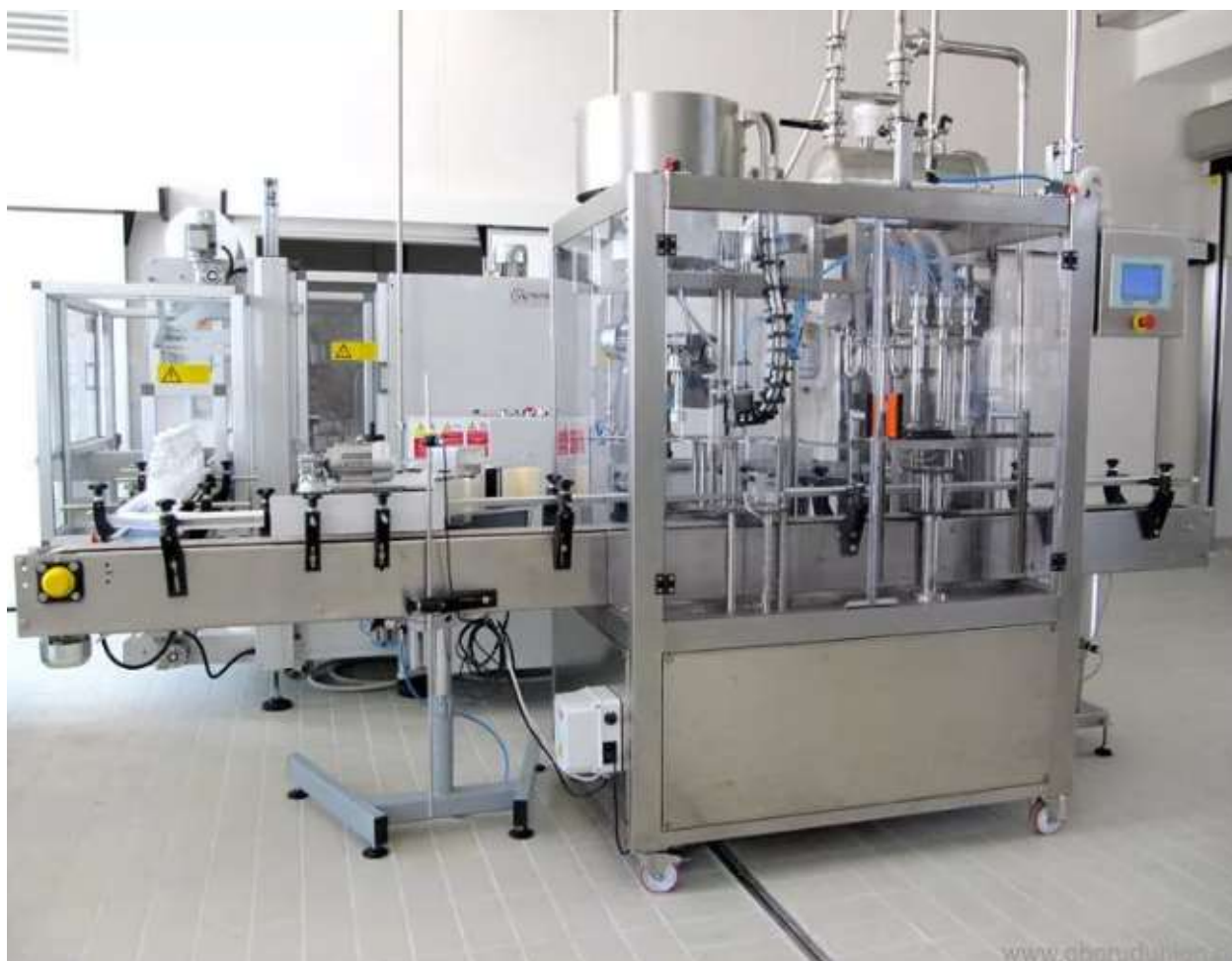
Автоматический розлив жидкостей – внешний вид комплекса
