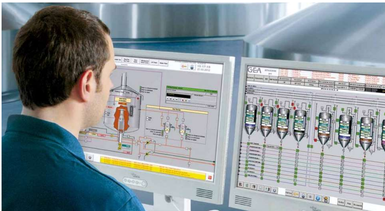
Рис. 9. Пример НМІ для контроля и управления технологическим процессом
