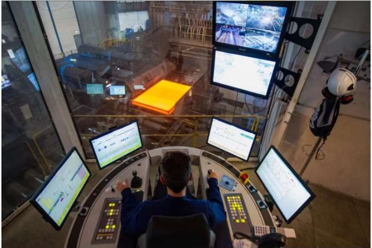
Пульт оператора на прокатном производстве НЛМК
