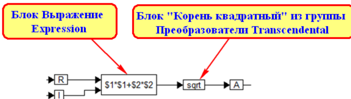
Рис. 5. Функциональная схема расчета АЧХ
