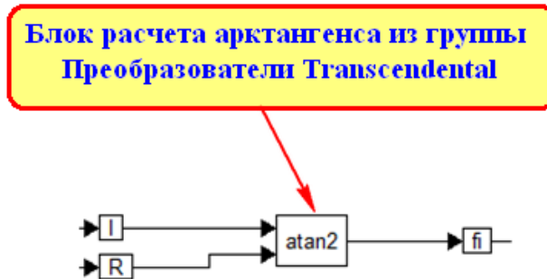
Рис. 6. Функциональная схема расчета ФЧХ
