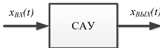
Рис. 2.1. Структурная схема САУ, представленной как «черный ящик»
