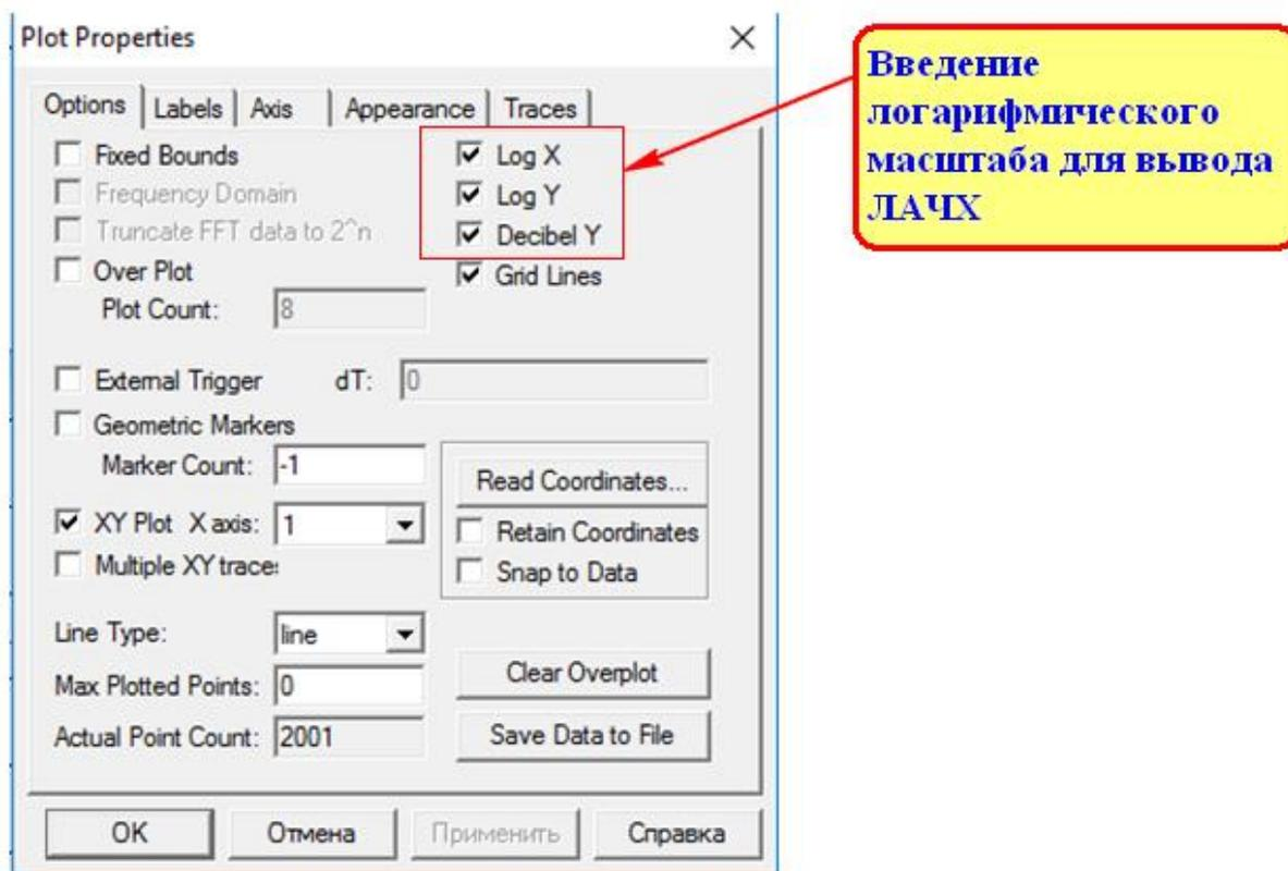
Рис. 1. Настройки осциллографа для вывода ЛАЧХ
