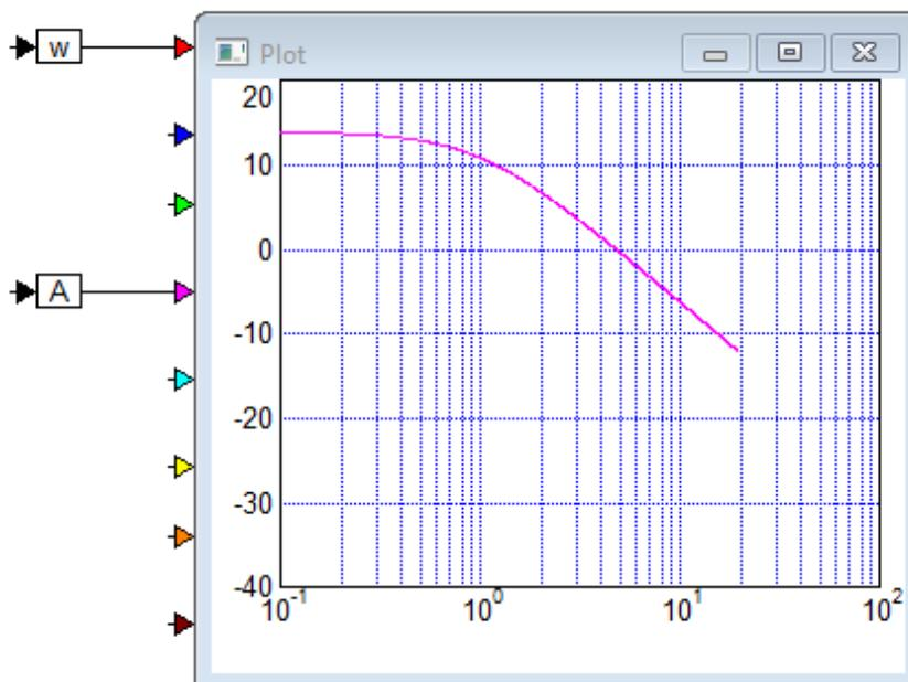
Рис. 2. Моделирование ЛАЧХ А-звена
