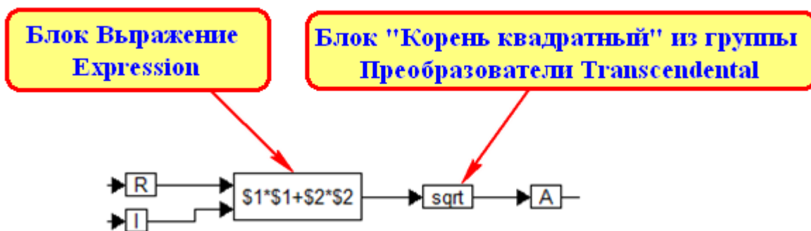
Рис. 3. Функциональная схема расчета АЧХ
