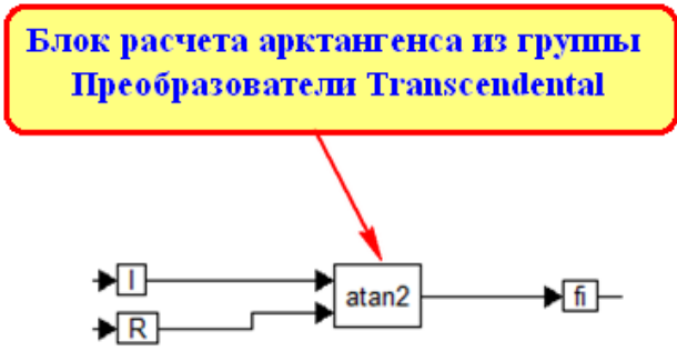
Рис. 4. Функциональная схема расчета ФЧХ
