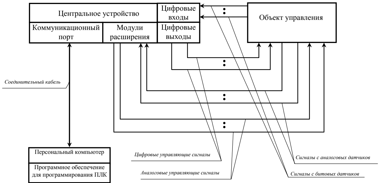
Рис. 1. Структурная схема системы управления электроустановкой полевого уровня на базе одного ПЛК.
