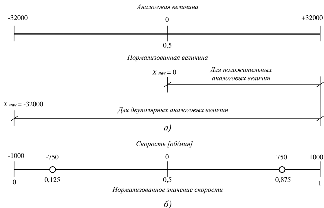
Рис. 15. Нормализация и масштабирование: а - в общем виде; б - для примера решения варианта 1 задания по теме 5
