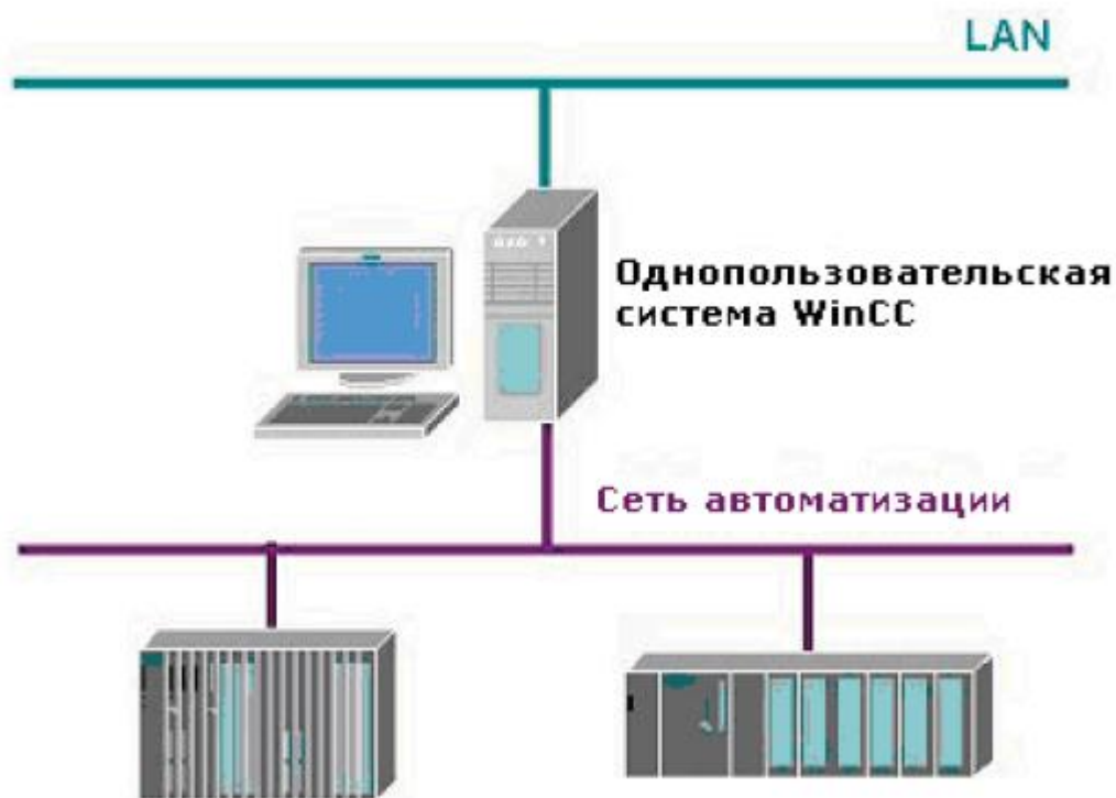
Рисунок 2. Однопользовательская система WinCC
