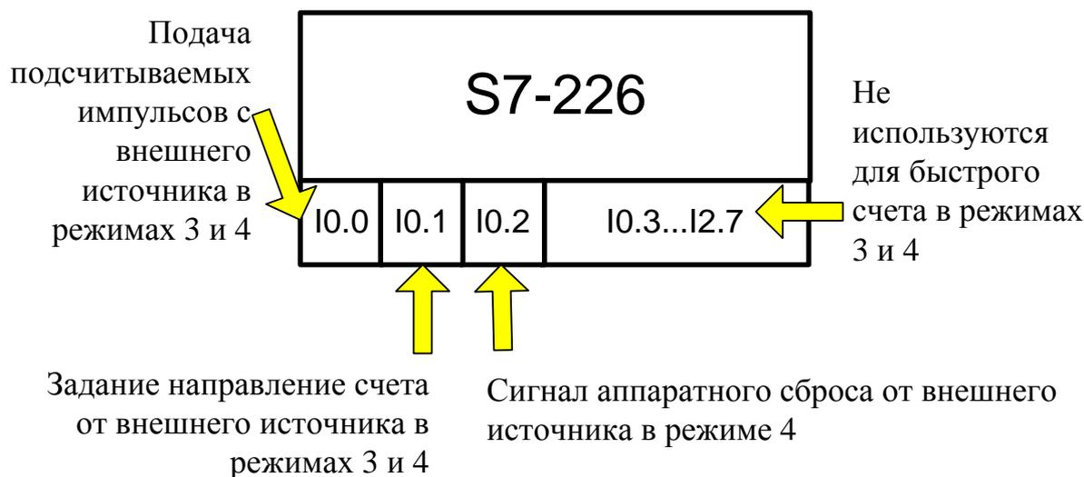
Рис. 4-12. Подача внешних сигналов на CPU для режимов 3 и 4 для HSC0
