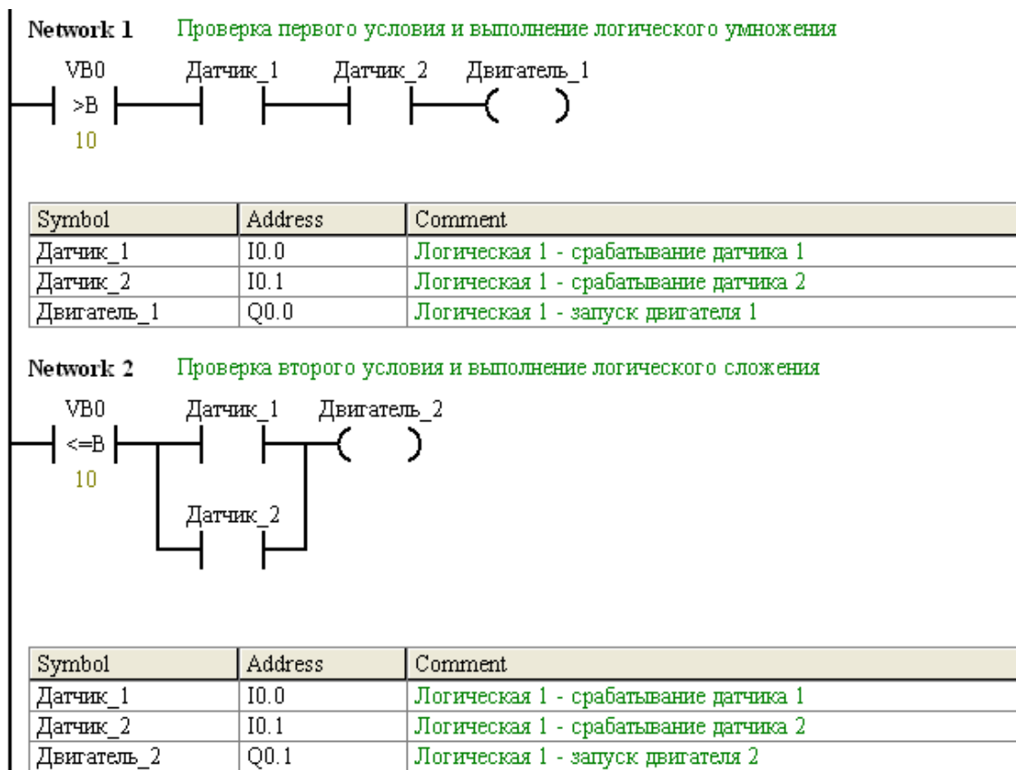
Рис. 2-16. Применение символьной адресации в редакторе LAD
